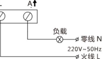
◆ 注意：严格按极性要求接线，接线错误将导致开关无法正常工作甚至损坏；产品的任何接线端子都严禁接零线。
